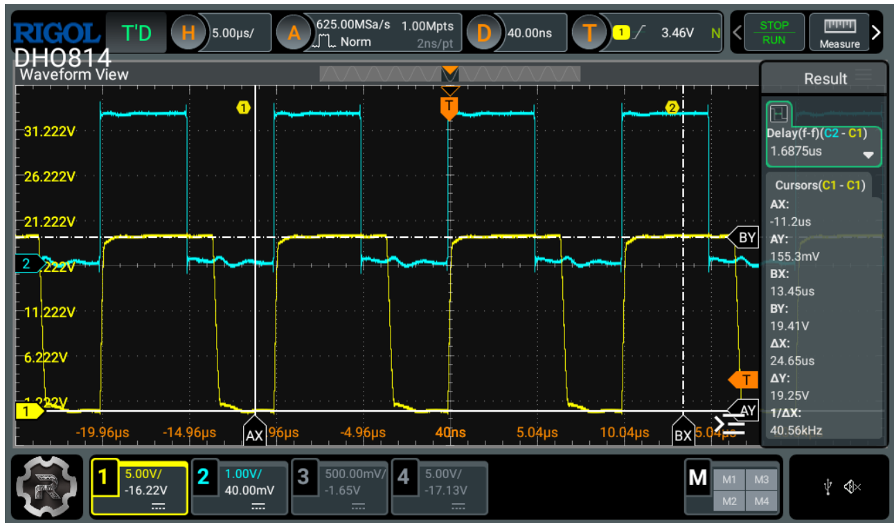
Figure 3: 高速邏輯電位轉換器測試之波形。
