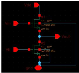
M1: W=1μm, L=0.5μm M2: W=1μm, L=0.5μm
