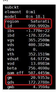
由 simulation result 可以看出 drain current 差不多等於  $1\mu A$ ,而又因為  $gain = -gm \times r_o$  以及  $r_o = 1/gds$ , $gain = -\frac{20.9353\mu}{172.2788n}\cong 121.519$ ,與 simulation result 非常相近。另外需要特別注意 mos 操作的區域,第一次我沒注意到 mos 並沒有在 saturation region 而是在 cut off region,卻仍得出正確的結果,可能是因為使用 static current,所以從表面上看不出差異,因此我又重新設計,確定 mos 在 saturation region 以後才確認結果。
