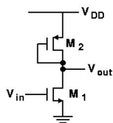
$$A_v \approx -g_{m1} \left( \frac{1}{g_{m2}} \parallel r_{o1} \parallel r_{o2} \right)$$
