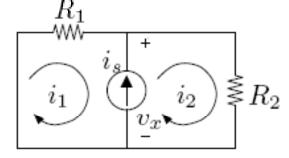
$$i_1 R_1 + v_x = 0; -v_x + i_2 R_2 = 0$$
