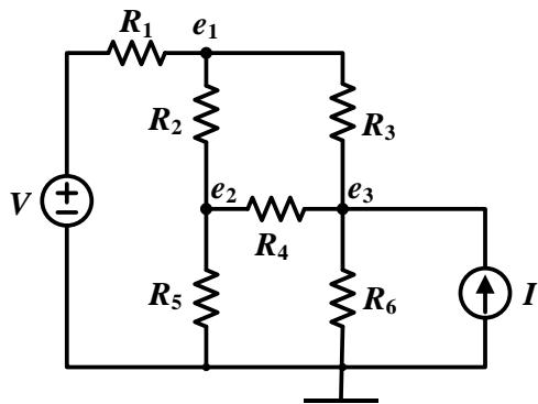
$$\text{Matrix Form: } \begin{bmatrix} G_{11} & G_{12} & G_{13} \\ G_{21} & G_{22} & G_{23} \\ G_{31} & G_{32} & G_{33} \end{bmatrix} \begin{bmatrix} e_1 \\ e_2 \\ e_3 \end{bmatrix} = \begin{bmatrix} S_1 \\ S_2 \\ S_3 \end{bmatrix}$$
