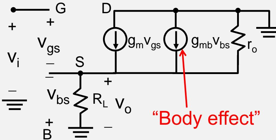
$$v_o = g_m v_{gs} (r_o // R_L) \quad (1)$$
