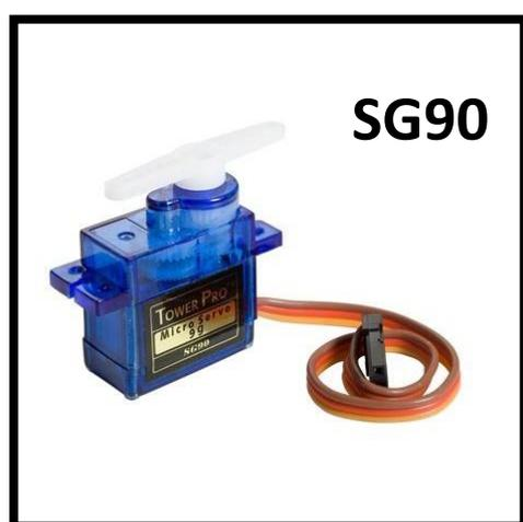
我們使用的伺服馬達的型號是 SG90，有三個接線，棕色的是接地 GND、紅色的是接正電、橘色的是接 PWM 脈衝信號，而控制伺服馬達的方式就是在 FPGA 輸出 PWM，把脈衝信號的週期固定在 50HZ(20ms)，並把高電位的持續時間維持在 1.0ms~2.0ms，就能控制角度在 $-90^{\circ}$ ~ $90^{\circ}$ 之間。
