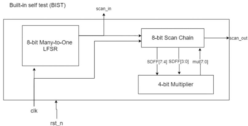
BIST 由 Many-to-One LFSR 、8 bit Scan Chain 和 4 bit multiplier 所組成。只是將 advanced question2 的 scan chain design 以 Many-to-One LFSR output 的 most significant bit 為 scan chain 的 input。
