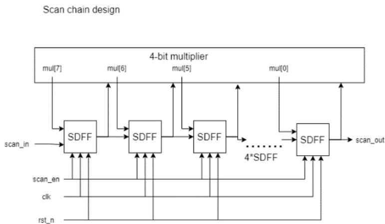
Scan Chain Design 是當  $\text{rst\_n} = 1' b1$  positive edge、 $\text{scan\_en} = 1' b1$  時， $\text{scan\_in}$  會 1 個 bit 1 個 bit 從左傳到右最後到 output  $\text{scan\_out}$ 。
