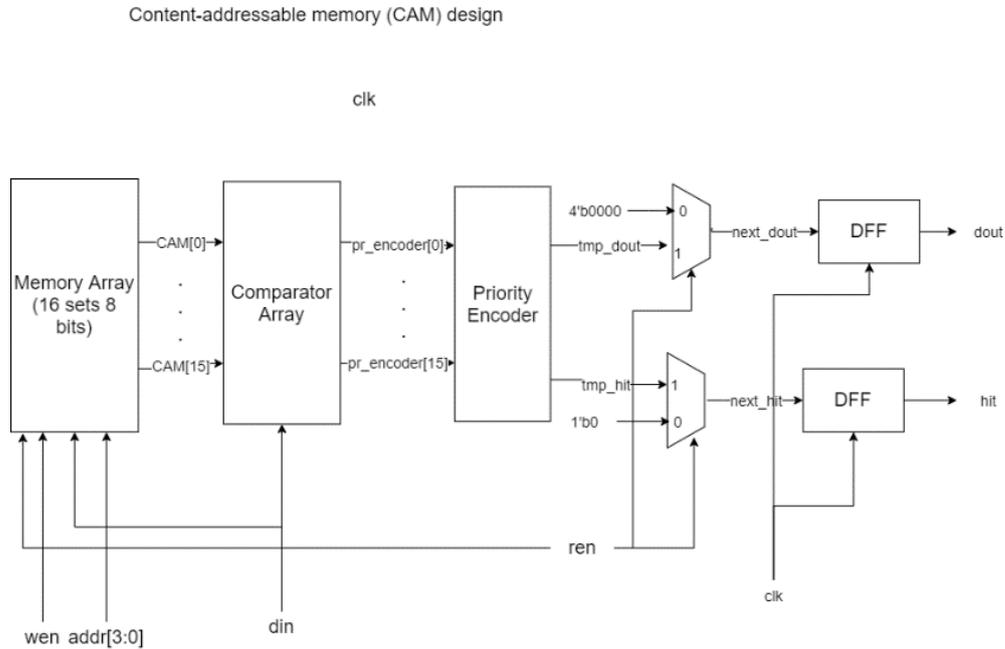
CAM 中的 memory array 用 reg [7:0]CAM[15:0]來模擬。當 ren == 1'b1 時，next\_dout = tmp\_dout，next\_hit = tmp\_hit。
