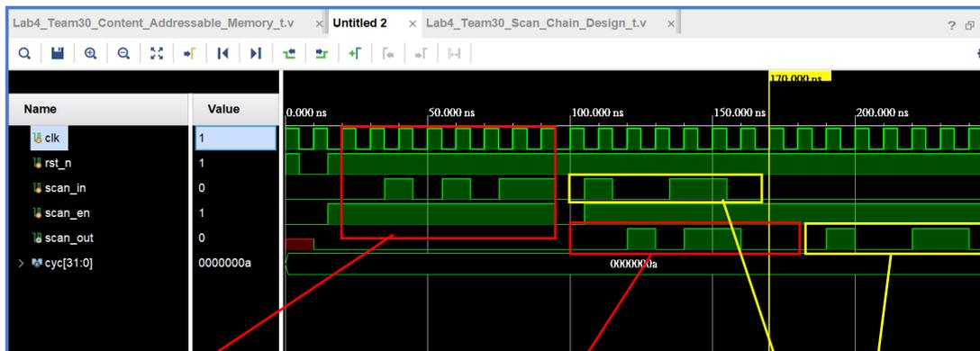
scan\_in 依序為 0,0,1,0,1,0,1,1 因為最早輸入的 scan\_in 最早傳到最右邊的 SDFF，因此我們的 2 個 4bit multiplier 的 input 為上述的值反過來，也就是 11010100，因此 2 個 input 為 1101 以及 0100。
