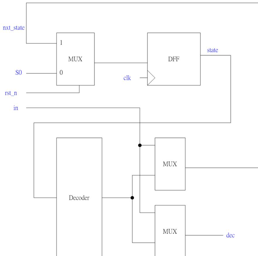
這題的 mealy machine sequence detector 要偵測 0111、1001、1110 三個 sequence，並在輸入四個 input 後就返回到 initial state 再次進行偵測，input 有 clk、rst\_n、in，output 是 dec，module 內部有 state、nxt\_state 來運作 mealy machine。一開始用一個 MUX 選擇如果  $\text{rst\_n} = 0$  的話輸入 S0 到 DFF，反之輸入  $\text{nxt\_state}$ ，接著 DFF 將 state 輸入到一個 decoder 判斷目前在哪個 state，最後再輸入到 MUX 由 in 判斷輸出 dec 的值與下個 cycle 的  $\text{nxt\_state}$ 。
