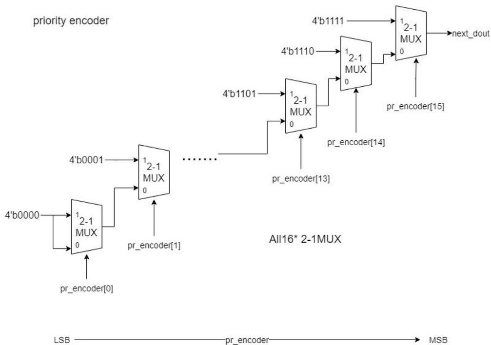
2<sup>n</sup> to n Priority Encoder 的功能是當 2<sup>n</sup> bit input 值的每一個 bit 中有 2 個以上的 bit = 1' b1，可以決定一個優先順序來決定 output。這時用普通的 encoder 會出現問題，因為普通的 encoder 限制只能有一個 bit = 1' b0 其他的 bit 則是 1' b1。我 16 to 4 Priority encoder 的實作是用 16 個 2-1 MUX 串起來。當 16 bit input 中有不只一個 bit 是 1' b1，我們需要優先順序 (這裡是 significant bit) 最高的輸入將會被優先輸出。
