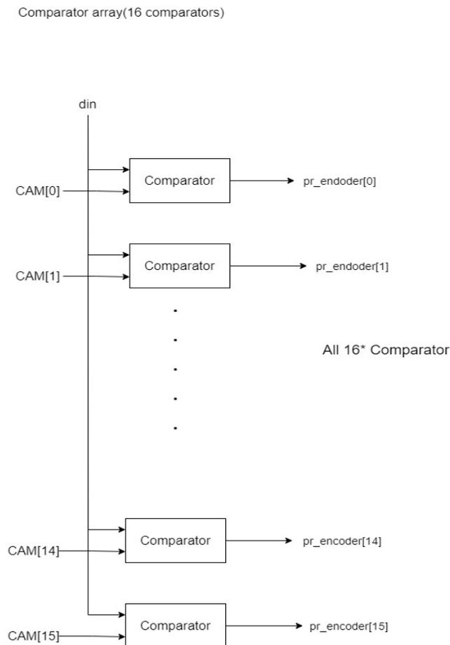
Comparator array 總共有 16 個 comparators。第一個 comparator CAM[0]跟 din 比較。如果兩個相等，則輸出 1' b1 否則輸出 0 並把輸出值指定給 pr\_encoder[0]。第二個 comparator 則是 CAM[1]跟 din 比較並把輸出值指定給 pr\_encoder[1]。第 i 個 comparator CAM[i-1]跟 din 比較並把輸出值指定給 pr\_encoder[i-1]。
