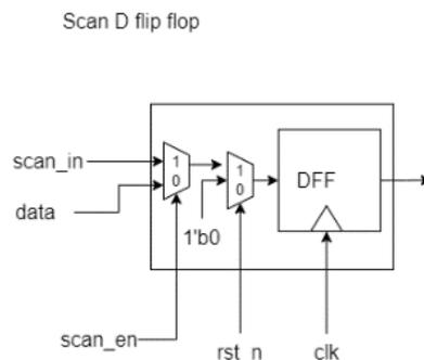
Scan DFF 由兩個 input signal  $\text{rst\_n}$  和  $\text{scan\_en}$  來決定甚麼值為 DFF 的 input。
