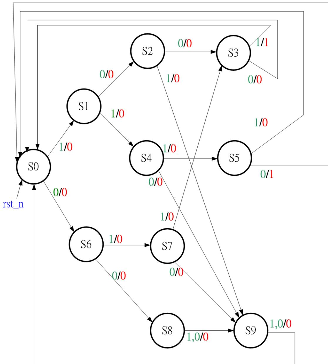
rst\_n == 0 時 state 會到 S0，然後開始接收 input sequence 並隨著 clk 變換 state，如果連續在四個 state 接收到 0111、1110 或 1001 的話會 output 1，不是以上的 sequence 則 output 0，而因為是 mealy machine，output 會由 state 和 input 決定，所以輸出是 asynchronous 的。所有的路徑都會在 4 個 cycle 之後再次回到 S0，重新偵測新的 4-bit sequence。
