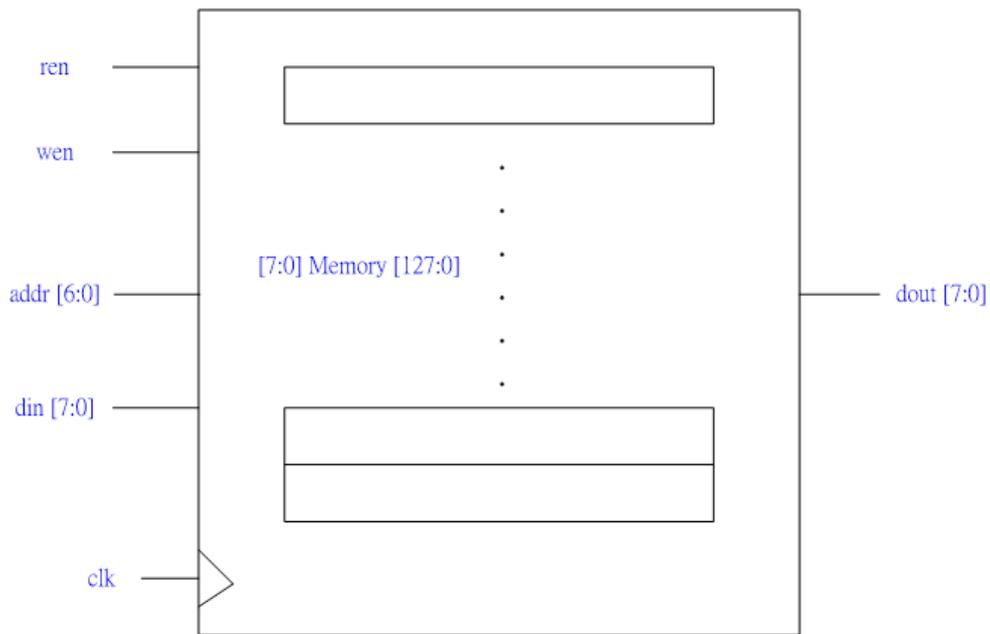
使用到 basic question 2 製作的 Memory，input 有 clk，ren、wen 下達 read 和 write 的訊號，addr 提供寫入的地址，din 提供輸入 Memory 的內容，output 有 dout 輸出 Memory 的內容。
