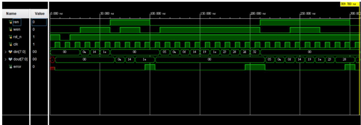
一開始先 reset，然後寫入三組內容再讀出，確認是否有按照 first in first out 讀出，並確認在 `wen = 0`、`ren = 1` 或 `wen = 1`、`ren = 1` 時只執行 read，嘗試讀出第四組內容時 `error = 1`；然後把 queue 寫滿，確認在寫入八組後就不再寫入且 `error` 輸出 1 最後全部讀出，確認之前輸入的 3 組數字不會再出現，並確認 queue 清空後要再讀出時 `error` 輸出 1。
