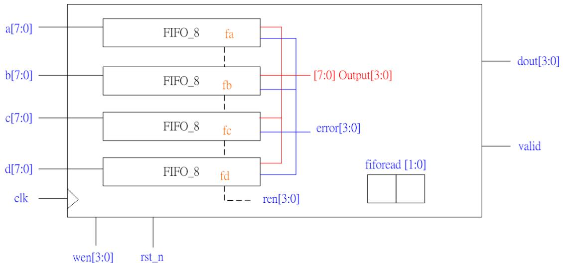
Round-Robin FIFO Arbiter 使用到 4 個在 advanced question 製作的 fifo queue，由 a、b、c、d input 儲存內容在 queue 中，其他 input 還有 clk、rst\_n、wen[3:0] 輸入 4 個 queue 的 wen 訊號。output 有 dout[3:0]，以及 valid 在無法正常輸出時給出訊號。Round-Robin
