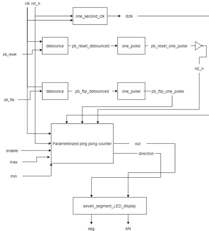
這裡的 parameterized ping pong counter 跟第 5 題有點不一樣，這裡的 parameterized ping pong counter 可以吃進 clock divider 的 clock。我們希望數字在顯示時，變動的數字是每 1sec 改變一次。而且我們希望按下按鈕時可以馬上改變數字的顯示或上下符號，所以也要吃進原來 fpga 的 clock( $10^{-8}$ sec)。只要在原本的 code 的 always block 中加入如果 `dclk==1'b1`，`out` 和 `direction` 會更新，如果 `dclk==1'b0`，`out` 和 `direction` 不變。
