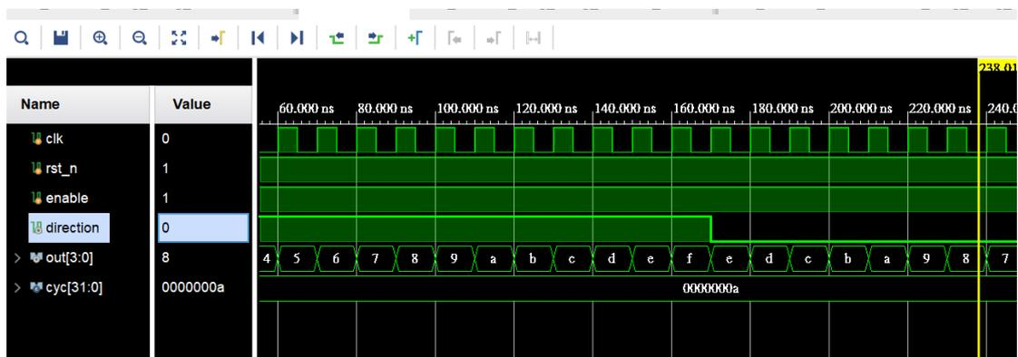
下圖是 enable == 1' b0 時的狀況，當 enable == 1' b0 時，out 和 direction 都會維持原來的值直到 enable == 1' b1 才會開始運算。
