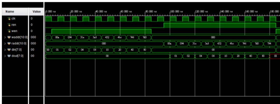
首先測試在每個 subbank 都寫入一組數字再照順序一一讀出看是否 write、read 的功能正常，再測試讀出一個額外的 address 是否會得到空的內容。
