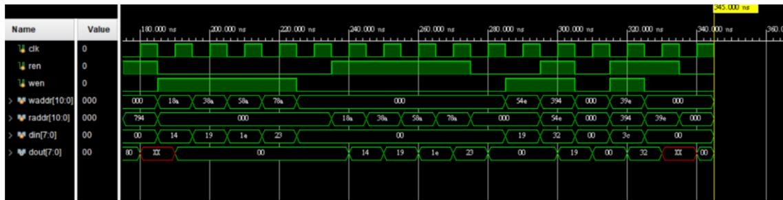
再來測試寫到 4 個 bank 的相同 subbank、address 是否能成功 read、write，最後測試是否能同時在不同的 subbank write、read，以及是否不能在同個 subbank write、read。
