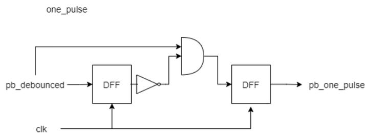
One pulse circuit 的作用是要 output 一個 clock cycle 的波。
