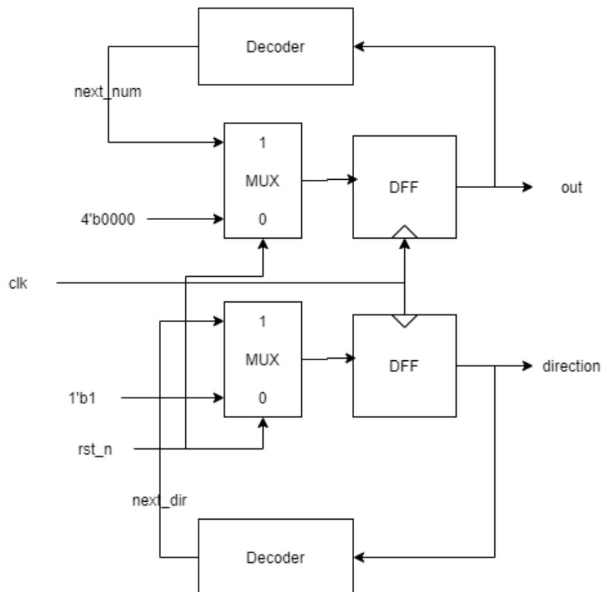
4-bit parameterized ping pong counter with max and min 有 6 個 input 和兩個 output。
