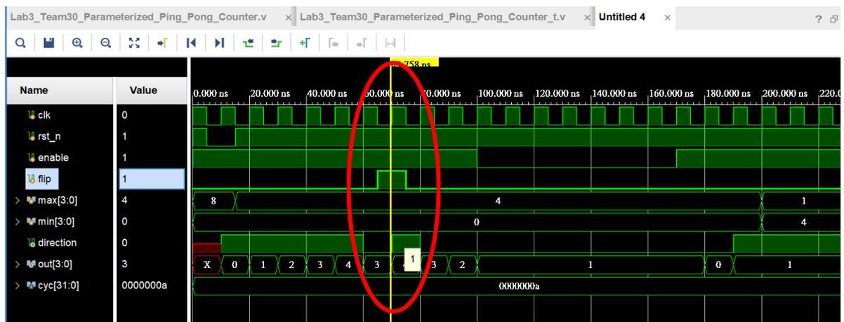
下圖是  $\text{enable} == 1$ 、 $\text{b0}$  時的波形圖，可以發現在  $\text{enable} == 1$ 、 $\text{b0}$  時， $\text{direction}$  和  $\text{out}$  都維持不變。
