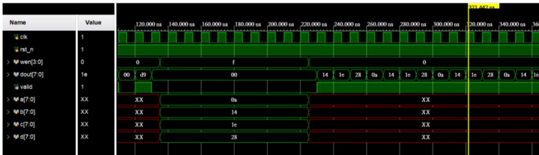
再來把 4 個 queue 清空，然後再把 4 個 queue 寫滿，並嘗試在每個 queue 寫入第 9 組數字，測試讀取的情況
