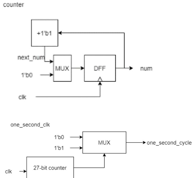
Clock divider 的作用是實作一個用 fpga 的 clock 除頻過後變成 1 秒的 clock。因為 fpga 的 clock 是 100MHz，也就是週期  $10^{-8}$  秒。所以我就用 1 個 sequential circuit 和 2 個 combinational Circuit 來做(也就是 1 個 counter 和 1 個 combinational)
