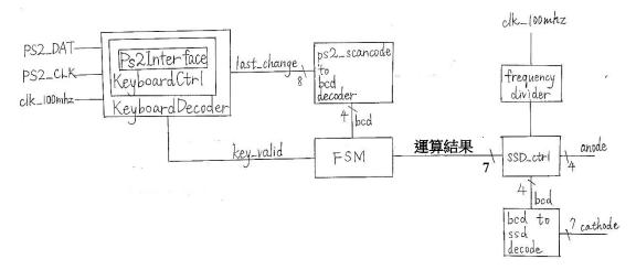
運算結果的 bit width 從一位數(4 bits,0~9)改成兩位數(7 bits,00~99),其餘同第二題。由於要輸入 operator 與 enter,所以 ps2-scancode-to-bcd decoder 除了要把數字 0~9 的 scan-code 轉成 bcd 之外,我把 a(加法)、s(减法)、m(乘法)、enter,這四個按鍵的 scancode 轉換成 4'hA、4'hB、4'hC、4'hD。因為在原本的 BCD 中,4'hA、4'hB、4'hC、4'hD是 unused,所以這麼做並不會影響到數字 0~9 的運作。本題的 FSM 有較大更動,上一題只需要四個 state,依序存入 addend、augend;本題則需要 12 個 state,依序存入 addend、augend 的十位數、個位數,以及 operator。
