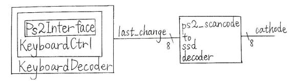
根據老師的課堂講解,KeyboardDecoder.v 的其中一個 output last\_change 的訊號 包含了被按下的按鍵的 scan-code。因此,只要將 last\_change 的訊號連接到一個 解碼器,將 scan-code 轉換成 SSD 即可。
