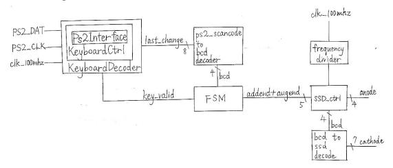
從 block diabram 可以看出,本題建立在上一題的基礎之上。上一題,last\_change 直接使用 look-up table 轉換成七段顯示器 cathode 的樣式。但在本題,由於要將輸入的數字相加,因此需要先轉換成可以被加法器理解的 BCD 形式。addend 與 augend 透過加法器相加後,再轉換成七段顯示器 cathode 的樣式。FSM 的 CLK 連接 key\_valid 作為時脈。其功能主要為判斷當下的 last\_change 在轉換成 BCD 之後,應當存入 addend、還是存入 augend。
