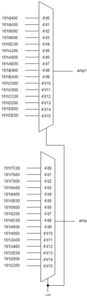
Counter 預設值為 8，所以預設負向振幅(amp1)為 16 進位的 B400；正向振幅(amp2)為 16 進位的 4C00。counter 每加 1，振幅就加上 16 進位的 0600；counter 每減 1，振幅就減掉 16 進位的 0600。
