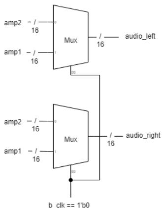
當  $b\_clk = 0$  時，輸入  $amp1$ ，也就是負向振幅；當  $b\_clk = 1$  時，輸入  $amp2$ ，也就是正向振幅，如此可以得到可以調振幅的音高頻率。
