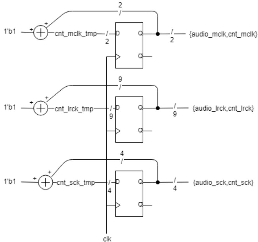
上圖為三個 binary up counter，每次的 clock 來就讓各個 counter 加 1，由於要除去  $100\text{MHz}/4$ 、 $100\text{MHz}/512$  以及  $100\text{MHz}/16$  的頻率，因此將各個 counter 的上限值由上到下設置為 4、512、16，取出 counter 的最高位數來看的話，第一個 counter 的最高位數以每 4 次的  $100\text{MHz}$  為一週期，頻率會等於  $100\text{MHz}/4$ ；第二個 counter 的最高位數以每 512 次的  $100\text{MHz}$  為一週期，頻率會等於  $100\text{MHz}/512$ ；第三個 counter 的最高位數以每 16 次的  $100\text{MHz}$  為一週期，頻率會等於  $100\text{MHz}/16$ 。如此便可藉由將 counter 中最高位數的訊號單獨拉出，來當作除頻過後的訊號。
