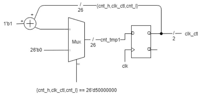
設計一個上限為 50M 的 binary up counter，在達到 50M 之前，每個 clk 都讓 counter 加上 1，而當 counter 數到 50M 時，便將 counter 歸零，將 counter 中的第 16、17bit(clk\_ctl)抓出來當作給 scan control 的控制項。
