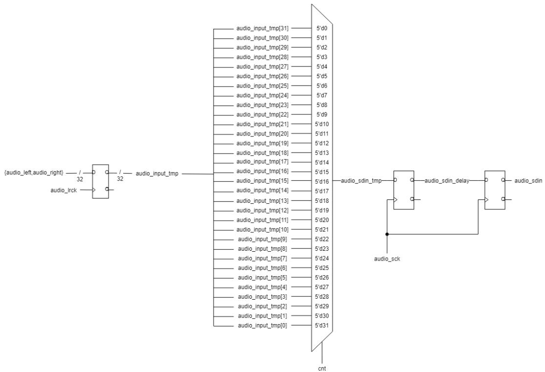
在 sample rate clock (audio\_lrck)來時用 32 bit 的 audio\_input\_tmp 來將左右兩聲道各 16 bit 的 parallel data 結合成 32 bit 並儲存起來，先前有提到用比 sample rate clock 還要快 32 倍的 serial clock(audio\_sck)來數 5 bit 的 cnt，因此就可以用 cnt 的值選擇 MUX 要選第幾 bit 的資料，在每一次 serial clock 來時將 32 bit 的資料輪流 1 bit、1 bit 的輸出，由於頻率相差 32 倍，所以一次 sample rate clock 就是 32 次的 serial clock，可以剛好將 32 bit 的資料全部輸出完畢，如此也有達到輸入的 bit 數等於輸出的 bit 數的原則。
