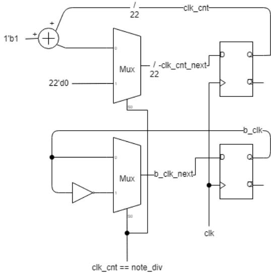
Do 的頻率為  $261\text{Hz} \rightarrow \text{note\_div}$  為  $\frac{100\text{MHz}}{261 \times 2} = 191571$ 。
