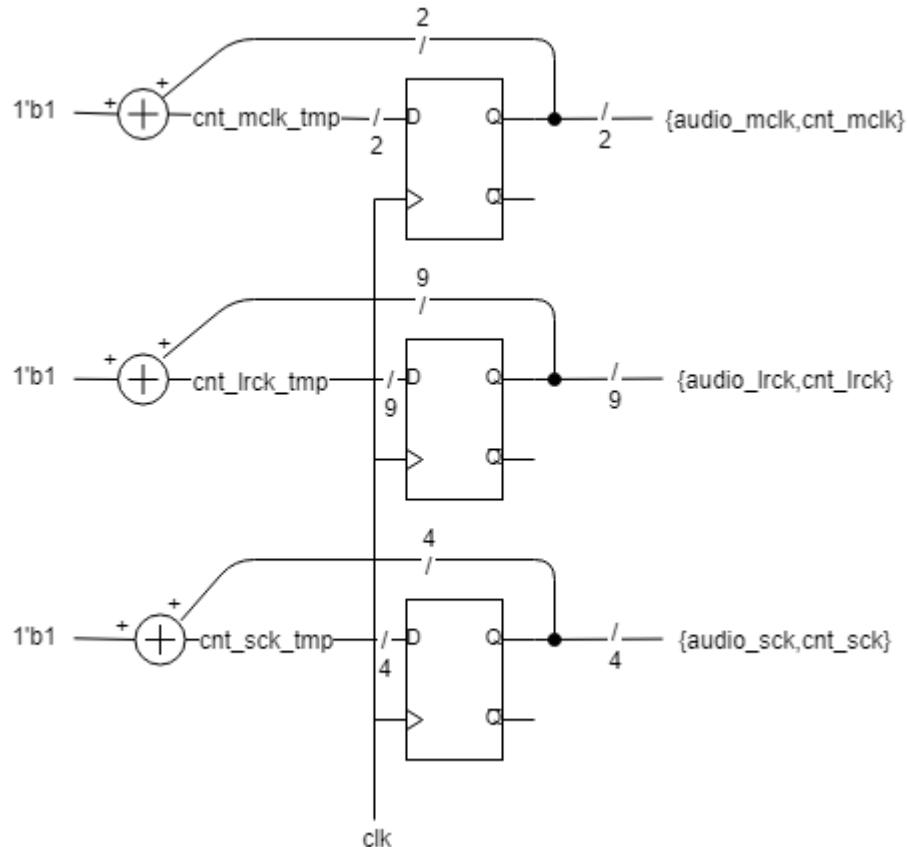
上圖為三個 binary up counter，每次的 clock 來就讓各個 counter 加 1，由於要除出  $100\text{MHz}/4$ 、 $100\text{MHz}/512$  以及  $100\text{MHz}/16$  的頻率，因此將各個 counter 的上限值由上到下設置為 4、512、16，取出 counter 的最高位數來看的話，第一個 counter 的最高位數以每 4 次的  $100\text{MHz}$  為一週期，頻率會等於  $100\text{MHz}/4$ ；第二個 counter 的最高位數以每 512 次的  $100\text{MHz}$  為一週期，頻率會等於  $100\text{MHz}/512$ ；第三個 counter 的最高位數以每 16 次的  $100\text{MHz}$  為一週期，頻率會等於  $100\text{MHz}/16$ 。如此便可藉由將 counter 中最高位數的訊號單獨拉出，來當作除頻過後的訊號。
