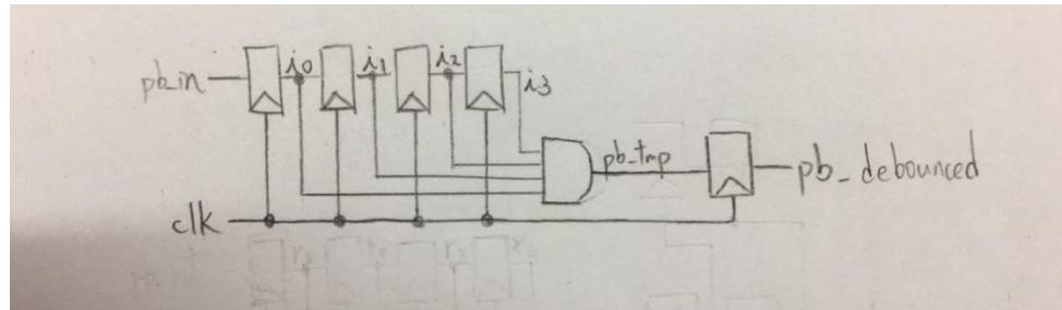
由於 push bottom 會產生 bouncing 的現象，因此將 push bottom 的輸入通過 4 個 flip flop 後，再將每個 flip flop 的輸出( $i_0 \sim i_3$ )通過 and gate，可以得到穩定的訊號值(pb\_debounced)。
