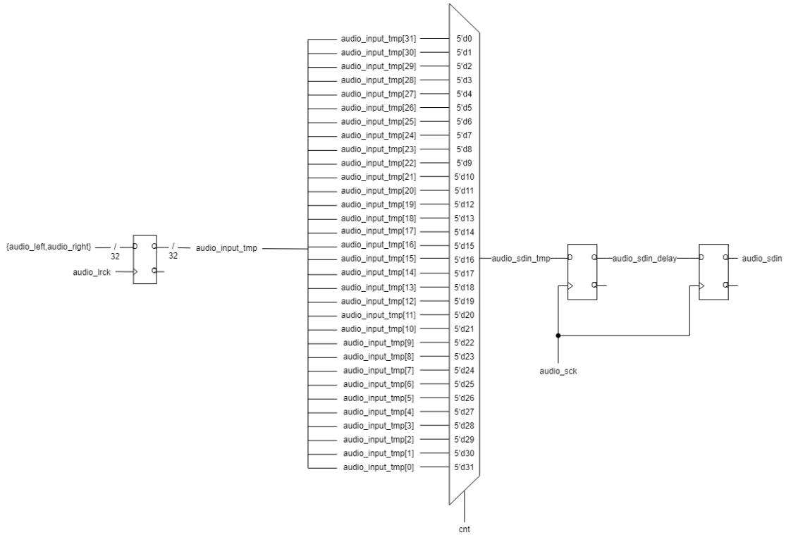
在 sample rate clock (`audio_irck`)來時用 32 bit 的 `audio_input_tmp` 來將左右兩聲道各 16 bit 的 parallel data 結合成 32 bit 並儲存起來，先前有提到用比 sample rate clock 還要快 32 倍的 serial clock(`audio_sck`)來數 5 bit 的 `cnt`，因此就可以用 `cnt` 的值選擇 MUX 要選第幾 bit 的資料，在每一次 serial clock 來時將 32 bit 的資料輪流 1 bit、1 bit 的輸出，由於頻率相差 32 倍，所以一次 sample rate clock 就是 32 次的 serial clock，可以剛好將 32 bit 的資料全部輸出完畢，如此也有達到輸入的 bit 數等於輸出的 bit 數的原則。
