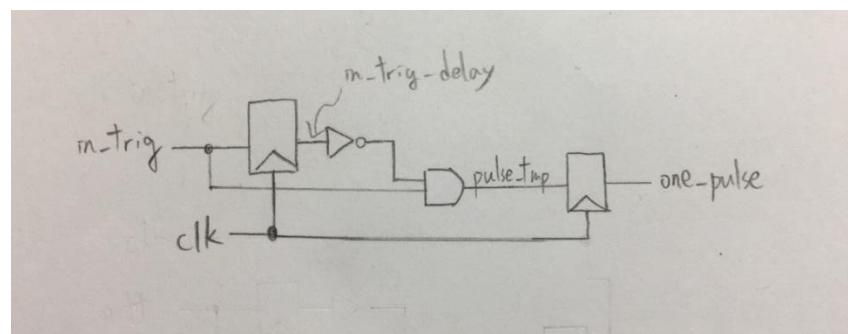
由於每次按下 push bottom 的時間都不一樣，要確保只在一個 clock 裡有輸入訊號，必須要經過上圖的邏輯來產生。將輸入(in\_trig)延遲一個 clock，得到 in\_trig\_delay，再將 in\_trig\_delay 與接下來的輸入(in\_trig)做 and，可以得到只有在一個 clock 裡有 positive signal 的輸出(one\_pulse)。
