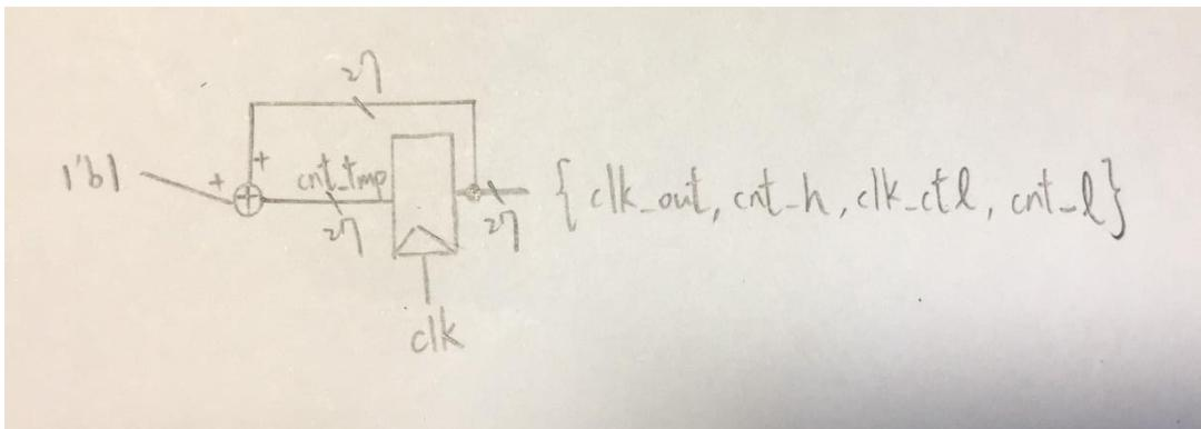
由於原本在 FPGA 板上的頻率為 100MHz，因此透過一個 27bit 的 binary up counter，並將此 27bit 的最高位數( $\text{clk\_out}$ )當作輸出，便可將頻率除到接近 1Hz ( $100\text{MHz} / 2^{27} \approx 0.745\text{Hz}$ )。另外再將 counter 中的第 16、17bit 抓出來當作 scan control 的控制項。
