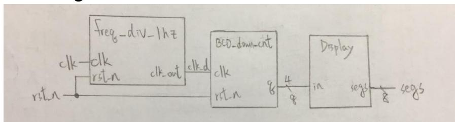
並將[3:0]ssd\_ctl 設為 4'b1110，使得七段顯示器只有顯示個位數。
