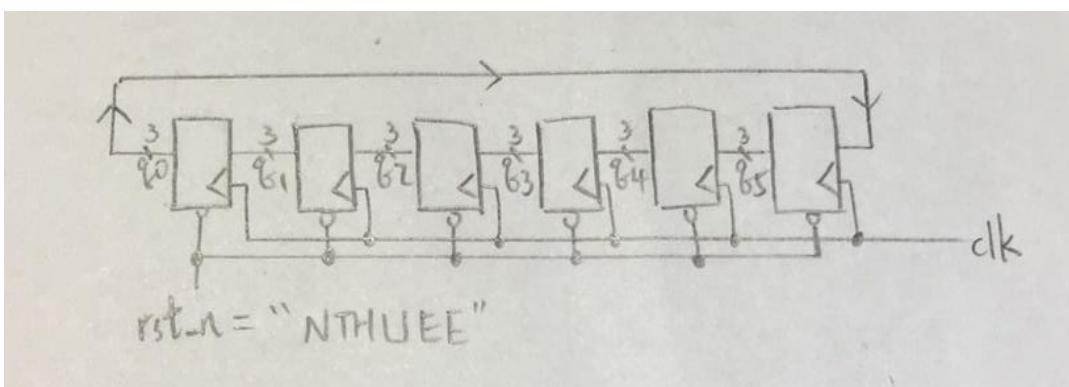
雖然有六組 3bit 的 DFF，但總共只有四個七段顯示器，因此將前四組 flip flop 的輸出( $q_3 \sim q_0$ )當作要顯示出來的英文字母。將每個英文字母配對到一個數字，當 reset 的時候，讓六組 flip flop 的輸出按照順序存入“NTHUEE”相對應的數字，並在每一次 clk 來時讓各組 flip flop 的值順時針移動，再把前四組 flip flop 的輸出抓出來，便可達到跑馬燈的效果。
