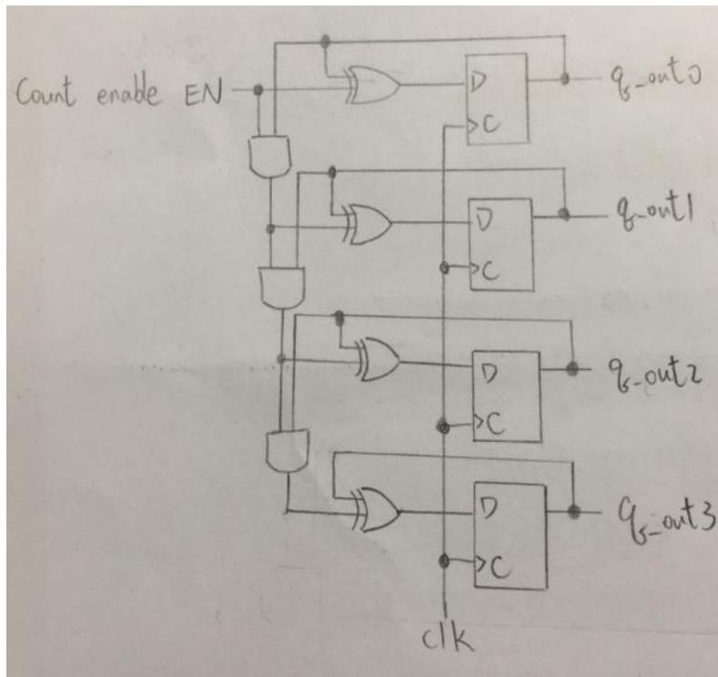
用四個 DFF 組成，在每個 1Hz 的 clock 觸發後，output (4bit 的 q\_out) 的值會等於 上一個 clock 的 q\_out 值 + 1。
