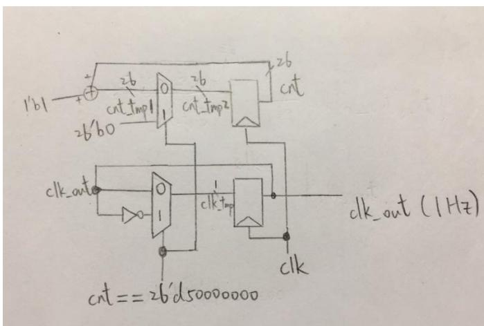
由於 FPGA 板上的頻率為 100MHz，建構理念是設計一個上限為 50M 的 binary up counter，在達到 50M 之前，每個 clk 都讓 counter 加上 1，而當 counter 數到 50M 時，便將輸出值(clk\_out) toggle 一次，也將 counter 歸零，如此下來，輸出值(clk\_out)在等於 0 和等於 1 的時間各自都是 50M 次的 clk，也就是說，clk\_out 的值 0.5 秒會 toggle 一次，因此輸出值的頻率將會等於  $100\text{MHz}/(50\text{M}*2) = 1\text{Hz}$ 。
