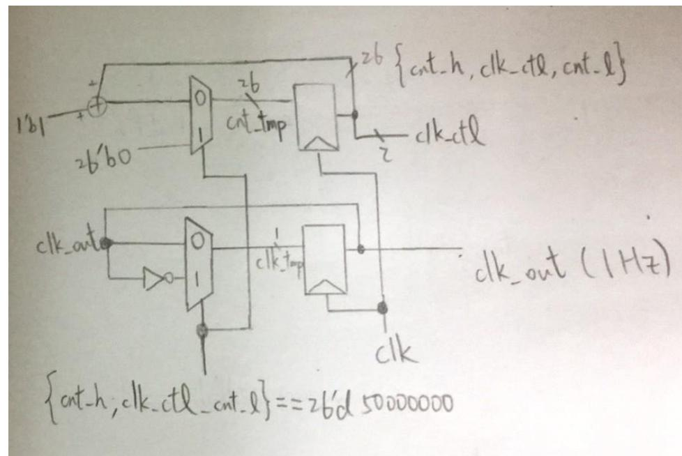
跟前幾小題不同的地方是這題的除頻器需要另外將上限為 50M 的 counter 中的第 16、17bit 抓出來當作 scan control 的控制項，如此可以藉由視覺暫留達成 4 個七段顯示器分別顯示各自數字的效果。
