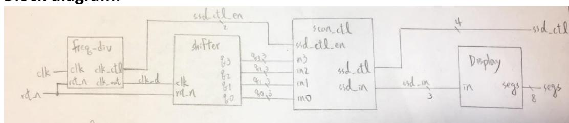
本實驗需要用到四個子 module，分別為除頻器、4bit 輸出的 shift register、scan control 以及 display decoder。
