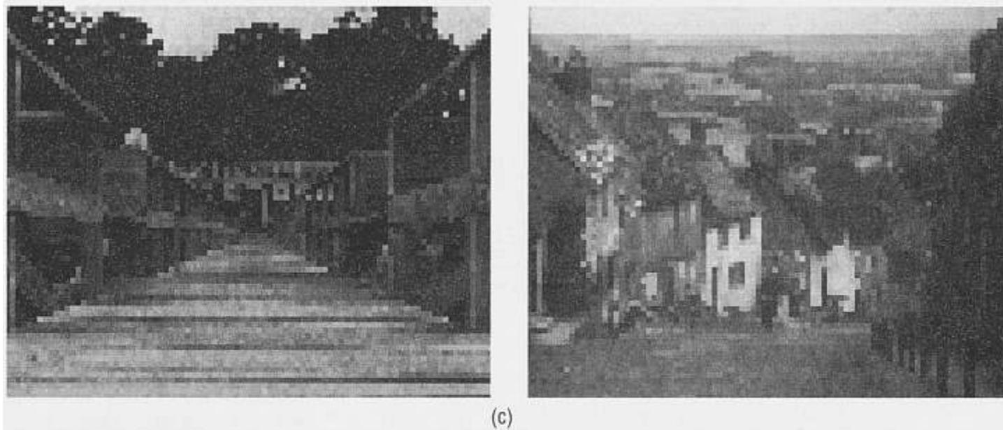
將脈衝取樣的水平及垂直間距改為 (b) 圖的 1/4 倍的結果。
