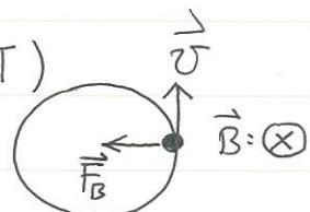
$\therefore r = \frac{mv}{\beta B}$ : 質譜儀 (mass spectrometer) 的原理 (Example 26.2)
