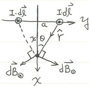
$\Rightarrow y$  分量抵消, 只有  $x$  方向分量的磁場.Similarly, on  $x-z$  plane 上的  $I \cdot d\vec{l}$  產生的  $\vec{B}$  也是有  $x$  方向. $\Rightarrow$  total current loop 產生的  $\vec{B} \parallel \hat{i}$
