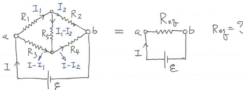
$R_{ef} = \mathcal{E}/I$ 。利用 node rule 標示, 如圖流經  $R_i$  的電流。
