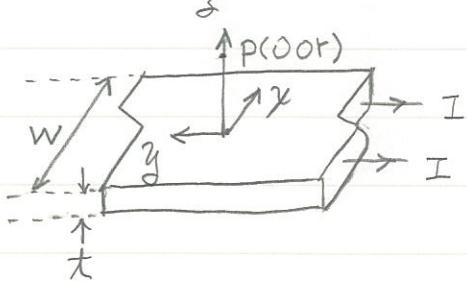
厚度  $t$  (z 方向), 寬度  $w$  (x 方向), 但若忽略長 (y 方向) 的 conductor sheet, 有 I 均勻地分布在 x-z 平面上, 由 +y 流向 -y, 如圖示。則  $P(0,0,r)$  的  $\vec{B} = ?$
