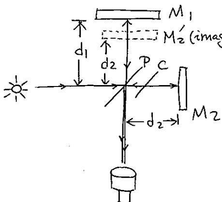
調整  $d_1$ , 使干涉圖樣產生變化
