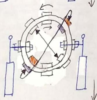
後起電盤上的電荷分布會因為中間電刷及前起電盤電荷分布的關係而對換。
