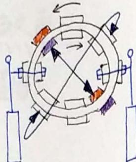
回到起始狀態，重複此循環動作。當萊頓瓶儲存大量的電荷後，會透過空氣放電。
