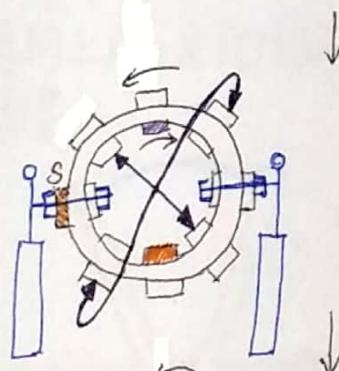
當繼續轉動後，金屬片  $S$  旋轉到左側集電瓶（萊頓瓶），便開始積電。
