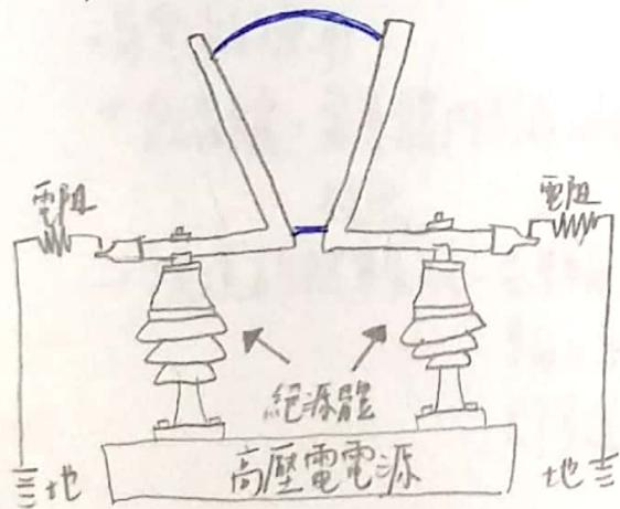
空氣在一般情況下是絕緣體，在施加電源後，空氣被離子化，由絕緣體變成導體，電弧在電桿之間的底部形成，並隨著電桿間的熱空氣上升而向上行進。當電弧長度逐漸增加時，它的功率耗損也會隨之增加，一旦兩電桿間的電壓不足以維持電弧的形成時，電弧便會熄滅並在電桿底部重新形成，過程重覆若干次。
