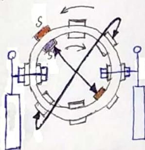
以二維的示意圖解釋韋氏起電機的構造。內圈順時針方向旋轉的是前方起電盤，外圈逆時針旋轉的是後方起電盤。如果後起電盤上金屬片  $S$  因摩擦而帶有正電荷，則前起電盤相對位置的金屬片  $S'$  會因感應起電而帶正電荷，經由電刷傳到對側的金屬片上， $S'$  就有較多負電荷
